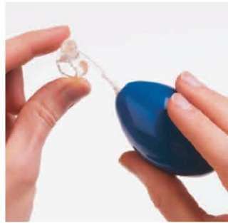
付属の掃除用ブラシを使って音の出口を下に向けてブラッシングします。
